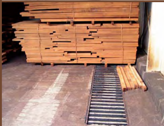
Slika 6.12. Unutrašnjost komore za indirektno parenje (foto: Pervan)
