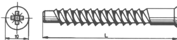
Slika 4.3.-37 Vijak s asimetričnim "sidrenim" navojem "Confirmat"
