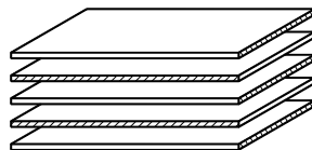
Slika 5.3.-19 Peteroslojna ili višeslojna (multiplex) furnirska ploča s vanjskim konstrukcijskim ili plemenitim furnirom
