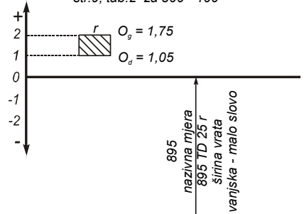
Slika 4.3.-26 Grafički prikaz položaja tolerancijskih polja za korpus i vrata
