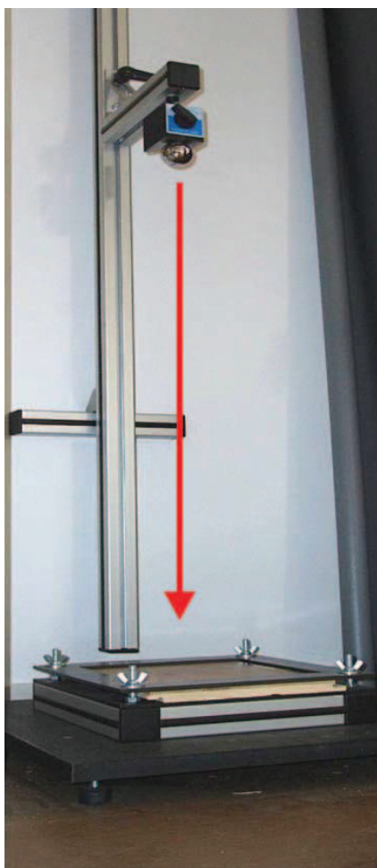
Slika 5: Padanje kugle (otpuštanjem magneta) na laminatnu podnu oblogu postavljenu u okvirnu stegu prema normi HRN EN 438-2 (lijevo) i nastali otisak s koncentričnim pukotinama na ispitnoj površini laka (desno)
