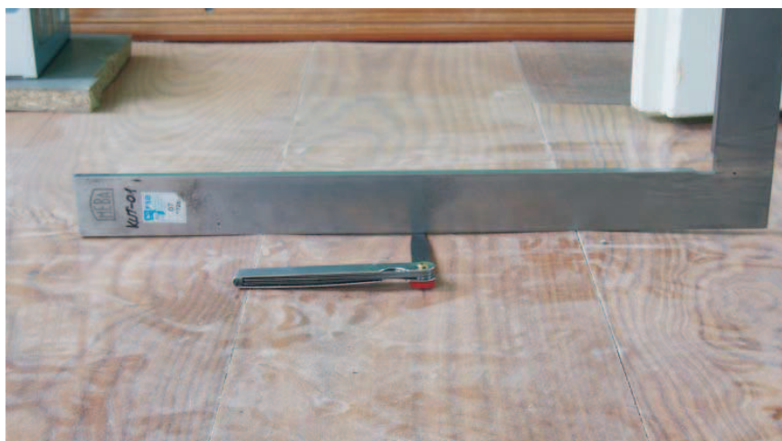
Slika 2. mjerenje koritavosti na ugrađenome podu pomoću ravnala i mjernih listića za zazure ("špijuna")
