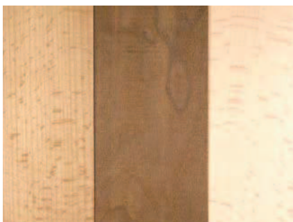
Slika 2: Blago i jako pregrijana bukovina (gore) i jasenovina (dolje) u usporedbi s prirodnim sirovinama
