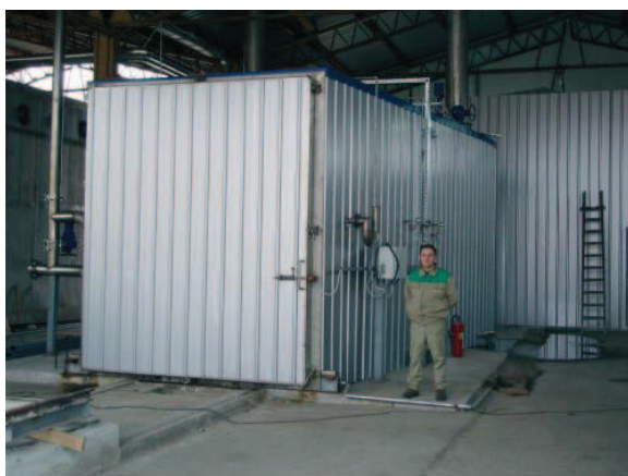
Slika 1: Postrojenje za pregrijavanje drva u pari (kapaciteta do 15 m 3 ) poduzeća za proizvodnju parketa PPS Galeković u Majuru
