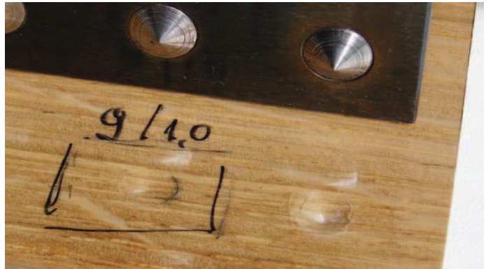
Slika 6: Blok sa stošcima (lijevo) i pukotina uzrokovana utiskivanjem stošca (desno)
