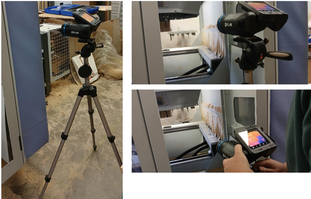
Slika 31. Mjerenje temperature s termalnom kamerom FLIR T560
