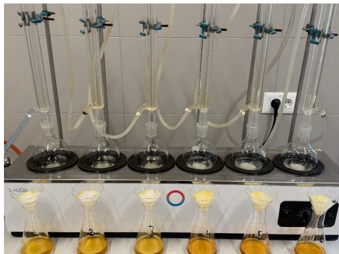
Slika 39. Određivanje udjela celuloze na vodenoj kupelji (Izvor: vlastita arhiva)
