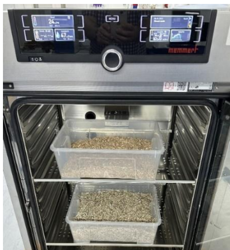
Slika 43. Kondicioniranje biomase za prešanje u klima komori (Izvor: vlastita arhiva)
