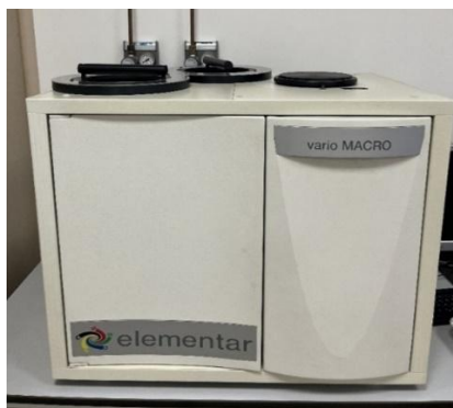
Slika 35. Analiza elementarnog sastava u CHNS analizatoru (Izvor: vlastita arhiva)
