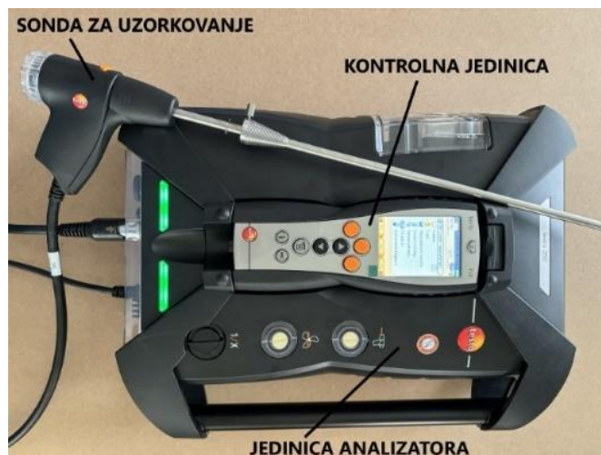
Slika 51. Analizator dimnih plinova TESTO 350 (Izvor: vlastita arhiva)
