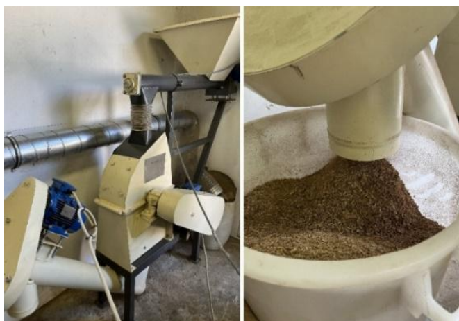
Slika 42. Usitnjavanje biomase za prešanje pomoću mlina čekićara (Izvor: vlastita arhiva)
