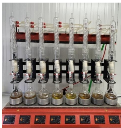
Slika 38. Analiza ekstraktivnih tvari pomoću Soxhlet ekstraktora (Izvor: vlastita arhiva)
