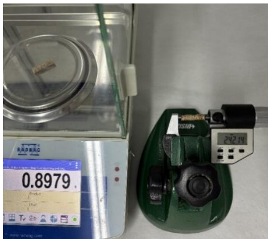
Slika 46. Analiza pojedinačne gustoće peleta (Izvor: vlastita arhiva)
