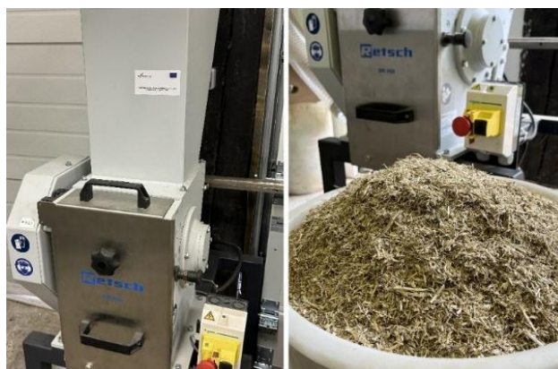
Slika 28. Usitnjavanje biomase na mlinu sjekaču (Izvor: vlastita arhiva)
