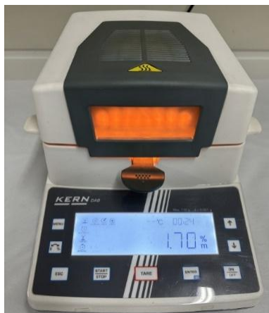
Slika 27. Određivanje udjela vlage na analizatoru KERN (Izvor: vlastita arhiva)
