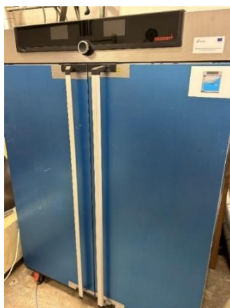
Slika 26. Sušenje drvene i poljoprivredne biomase u sušioniku (Izvor: vlastita arhiva)
