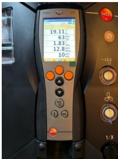
Slika 53. Prikaz mjerenja koncentracija plinova (Izvor: vlastita arhiva)
