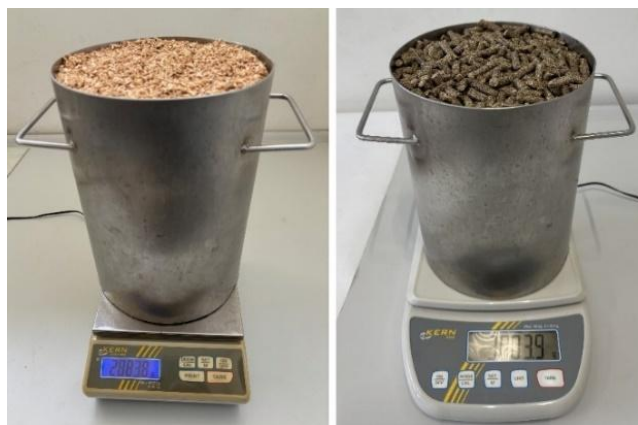
Slika 32. Određivanje nasipne gustoće biomase i peleta (Izvor: vlastita arhiva)
