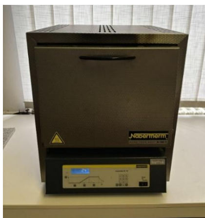
Slika 34. Analiza udjela pepela u mufolnoj peći (Izvor: vlastita arhiva)
