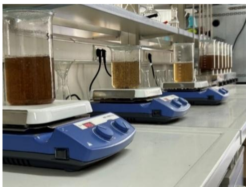
Slika 40. Analiza udjela lignina pomoću magnetne mješalice s grijačem (Izvor: vlastita arhiva)
