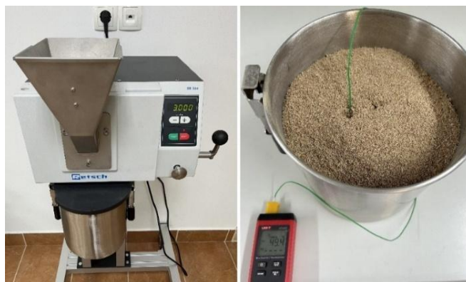
Slika 29. Usitnjavanje biomase na mlinu čekićaru i kontrola zagrijavanja uzorka (Izvor: vlastita arhiva)
