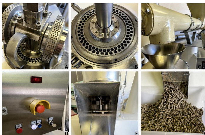
Slika 45. Konstrukcijski dijelovi preše i postupak prešanja (Izvor: vlastita arhiva)
