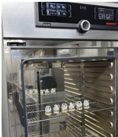
Slika 33. Određivanje udjela vlage u laboratorijskom sušioniku (Izvor: vlastita arhiva)
