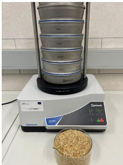
Slika 31. Prosijavanje uzoraka na sitotresilici (Izvor: vlastita arhiva)
