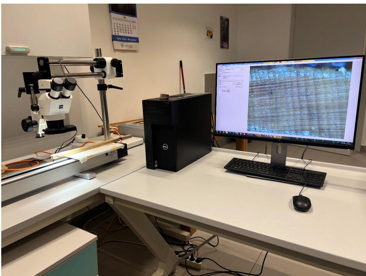
**Slika 36.** Analiza skeniranih uzoraka pomoću sustava ATRICS
